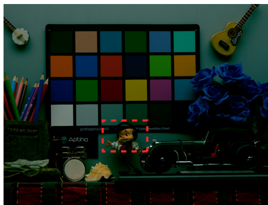
Рисунок 8: Датчик MT9H004 Aptina с технологией Aptina DR-Pix с режимом HCG включен, что приводит к более высокой чувствительности и низкий уровень шума. Посещение в 144 лк дневном освещении и 125 мс экспозиции.
