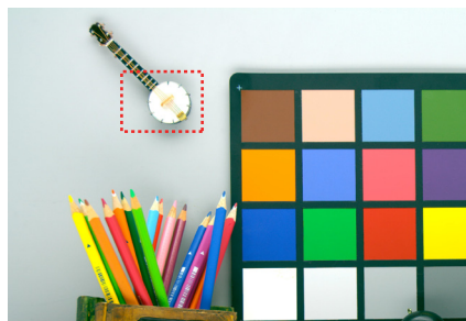
Рисунок 12: Правильно выдержан яркий свет сцены, 2430 лк дневной освещительный, 125 мс, обеспечиваемый в режиме LCG из MT9H004 датчика Aptina с технологией Aptina DR-Pix.
